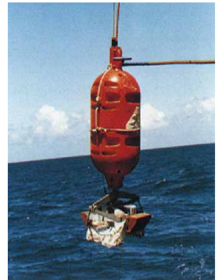
フリーフォールクラブ (マンガン団塊採取機器)
