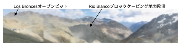
図 10 CODELCO Andina 鉱山 Rio Blanco 鉱床地表と Anglo American Chile Los Bronces 鉱床オープンピット。オープンピットは山陰でこの写真では見えない。両鉱床を跨ぐ大規模露天採掘計画がある（2005 年 1 月 29 日撮影）
