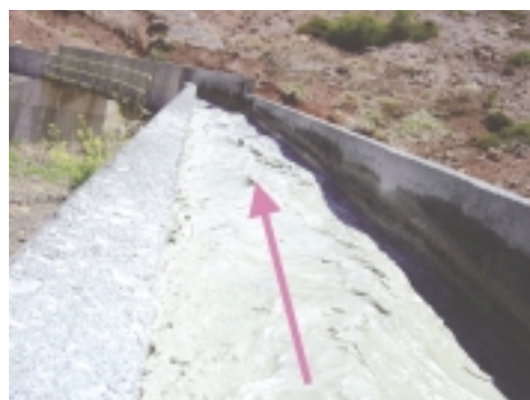
写真2：Colon選鉱場の尾鉱流送機（尾鉱発生量4,463万t/年、品位Cu0.111%（2005年データ））
