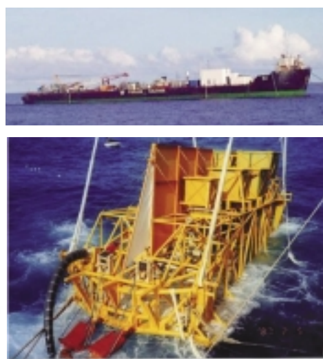
図3 日本の海山における集鉱実験概要、実験台船、曳航式集鉱機 8)
