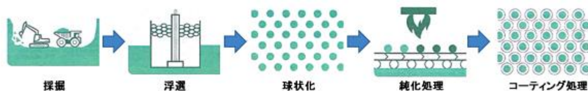
図9 天然産グラファイトをリチウムイオン電池に使用するための処理プロセス 9
