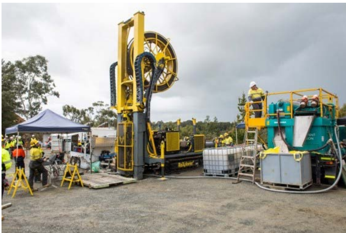
写真 コイルチューブ試錐機（RoXplorer）の様子
