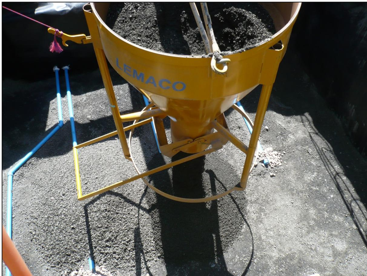
アグロメレーションを硫酸で行うことに加え、鉱石積込み時になるべく人が鉱石上に乗らないように、左写真のように鉱石を上部から落として積み込んだ。
